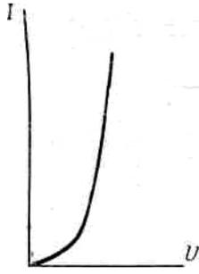
Рис. 16.9. Вольт-амперная характеристика полупроводника.
