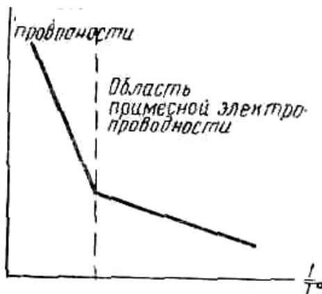
Рис.16.12.Области собственной и примесной электропроводности в зависимости от температуры в полупроводнике
