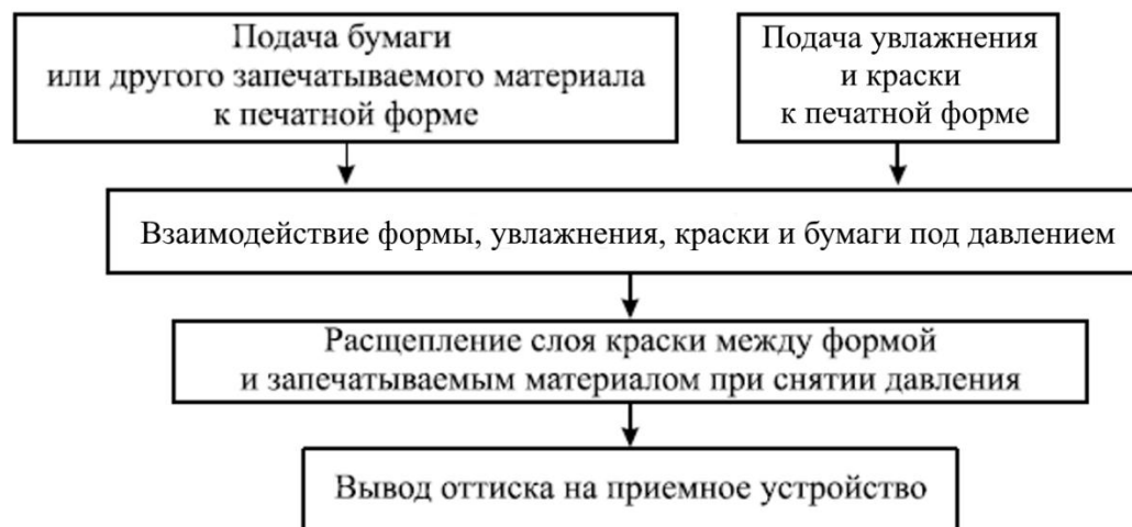
Рисунок 1 - Обобщенная технологическая схема классического печатного процесса
